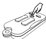
*В любом из перечисленных режимов нажмите клавишу 4 (рис. 15). Прибор перейдет в режим естественной вентиляции.*
